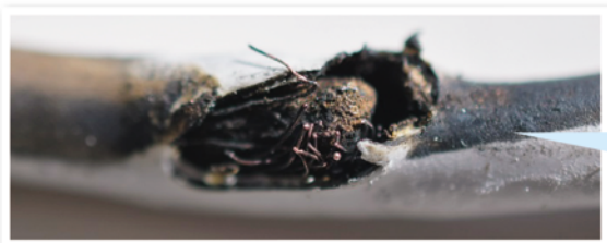
顕微鏡で観察した コードの焼け跡部分
