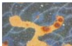
【写真4】白い線は表面のガラス質に入ったひびひびは空焚きなどが原因で生じる
